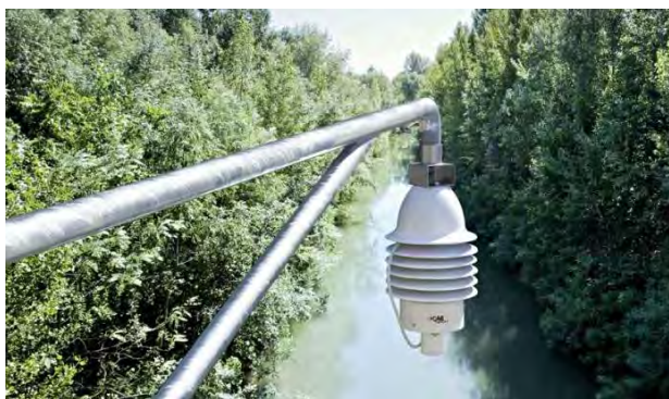
Figura 4.5 – Idrometro ad ultrasuoni per la misura del livello idrometrico.
